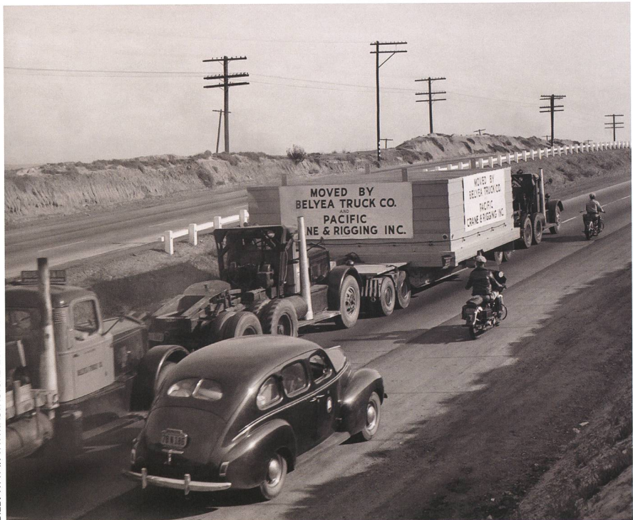
Abbildung 3: Endlich war es soweit. Nach jahrelangen Schleifarbeiten, unterbrochen durch den 2. Weltkrieg, wurde der Spiegel im November 1947 per Autotransport zum Palomar Mountain gefahren. Dazu waren zwei Lastwagen nötig, einer zog, der andere schob den 14 t schweren Glasklotz.
