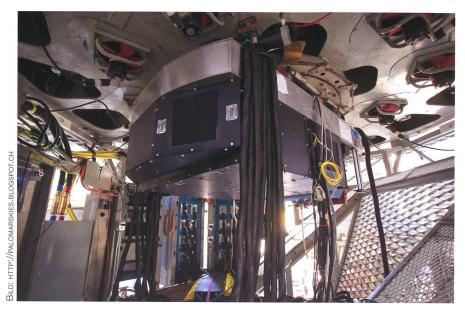
Abbildung 7: PALM-3000, die adaptive Optik, die wie eine variable Brille unter dem Hauptspiegel des Hale-Teleskopes montiert worden ist. Das Gerät kann die atmosphärischen Störungen zu einem enorm hohen Teil ausgleichen. Dafür sorgen 3'388 kleine «Aktuatoren», die einen plastischen Spiegel ständig neu verformen. Es soll u. a. für die Jagd nach extrasolaren Planeten eingesetzt werden.
