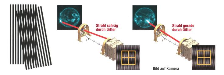
Abbildung 3: Der Moireeffekt. Durch Überlappen von zwei zueinander geneigten Gittern entsteht ein Muster. Rechts: Röntgenstrahlen von der Sonne fallen je nach ihrem Ursprung mit verschiedenen Winkeln auf die Gitter, was zu verschiedenen Mustern auf der Kamera führt. Die orangen Quadrate symbolisieren 4 Beispielpixel auf der Kamera. In den zwei Beispielen sieht man, dass die Pixel je nach Einfallswinkel verschieden hell sind und somit kann man zurückrechnen, wo die Röntgenstrahlen herkamen.
