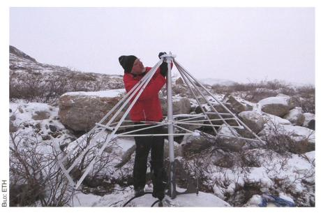
Abbildung 1: LWA-Antenne, montiert auf einem Felsen. Rentiere sollen die Antenne nicht als Kratzbürste missbrauchen. Die Gewindestangen zur Befestigung der Montierung wurden mit speziellem, kältetauglichem Kleber in vorgebohrte Löcher im Felsen eingeklebt. Bei –20°C ist die Bastelei an der Antenne für den Autor gewöhnungsbedürftig und nicht trivial.
