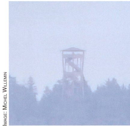
Figure 6: Même scène, détail B, observé au travers du système téléobjectif Canon EF 400mm f/5.6 L, muni d'un oculaire orthoscopique de 18mm. Photographie prise via Smartphone avec zoom numérique activé. Distance de la tour : 17.2 km.
