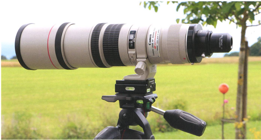
Figure 3: Le téléobjectif Canon EF 400 mm f/5.6 L est équipé d'un adaptateur EOS EF Canon vers le coulant de 1¼" (31.75 mm). Cela permet l'installation d'oculaires pour une observation visuelle très agréable. Dans le cas présent, un oculaire orthoscopique de 18 mm fournit un grossissement de 400/18 = 22 fois.
