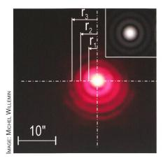
Figure 7: Image de diffraction du téléobjectif Canon EF 400 mm f/5.6 L. Les minimaux, positions d'interférences destructives sont mesurés à  $r_1$  = 2.3",  $r_2$ = 4.4" et  $r_3$  = 6.7". Généralement, c'est  $r_1$  = 1.22 ·  $\mathcal{N}$ D, qui donne le pouvoir séparateur de l'instrument. L'insertion en haut à droite illustre une image de diffraction théorique.
