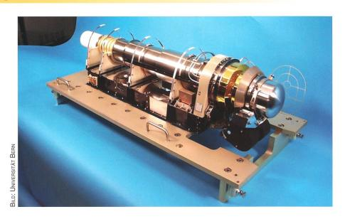
Abbildung 2: Das Massenspektrometer ROSINA lieferte sensationelle Daten.
