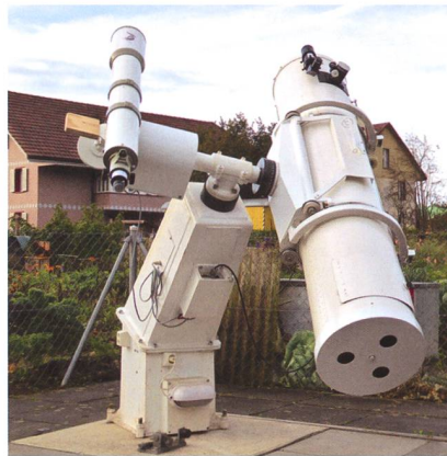
Abbildung 2: Das 30 cm-Newtonteleskop und der Vixen-Refraktor sitzen auf derselben Montierung.
