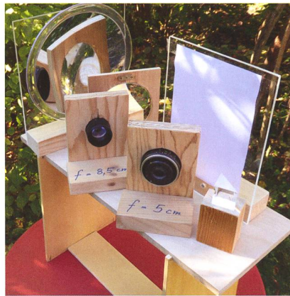
Abbildung 9: Bauteile für optische Experimente zur Funktionsweise von Feldstecher und Fernrohr.
