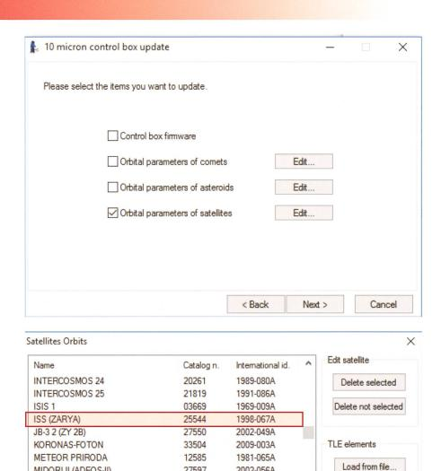
Abbildung 3: Die Datenübertragung auf die 10microm-Steuerbox erfolgt via «Orbital parameters of satellites». In der Satelliten-Liste können die aktualisierten Überflugdaten abgerufen werden.
