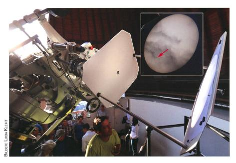
Abbildung 1: Der Urania-Hauptrefraktor ist mit der Projektionseinrichtung ausgestattet. So liess sich der Merkurtransit am 9. Mai 2016 trotz vorbeiziehender Wolken recht gut verfolgen.
