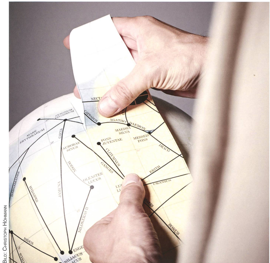
Abbildung 3: Hier ist Hochpräzision gefragt. Streifen um Streifen klebt MICHAEL PLICHTA die vorgefertigten sphärischen Kugelzweiecke auf den Globus.
