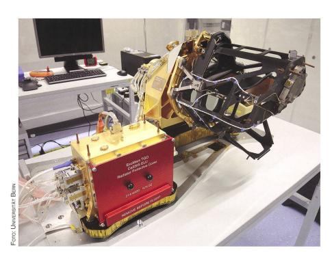
Abbildung 1: CaSSIS vor der Montage auf die ExoMars-Sonde.
