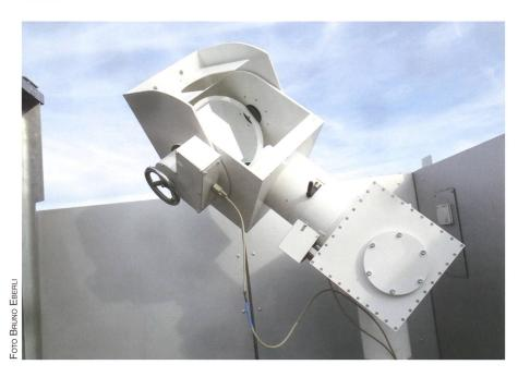
Abbildung 1: Der Heliostat befindet sich direkt auf dem Dach des Planetariums und fängt das Sonnenlicht ein.
