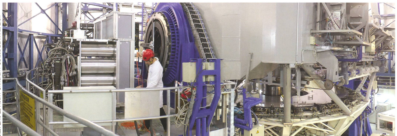
Abbildung 1: Diese Aufnahme zeigt das VLT-Teleskop 4 (Mitte) und das neue MUSE-Instrument (links). Dank 24 Integralfeldspektrographen hat MUSE ein enormes Potential für neue Entdeckungen, da es bis zu 90'000 Spektren pro Aufnahme liefert.
