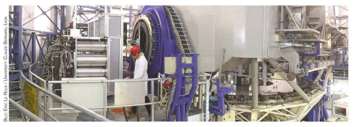
Abbildung 1: Diese Aufnahme zeigt das VLT-Teleskop 4 (Mitte) und das neue MUSE-Instrument (links). Dank 24 Integralfeldspektrographen hat MUSE ein enormes Potential für neue Entdeckungen, da es bis zu 90'000 Spektren pro Aufnahme liefert.
