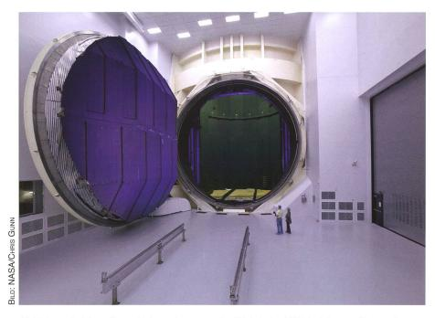
Abbildung 6: Die grösste Vakuumkammer der Welt beim NASA Johnson Space Center wurde für die Apollomission konstruiert. Nun wird sie für JWST umgebaut, um die Tieftemperatur von unter -220°C zu ermöglichen. Das Teleskop wird darin monatelang auf Sehschärfe und andere Eigenschaften getestet.
