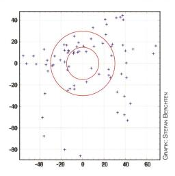
Abbildung 5: Zielabweichung nach Implementierung der Kalibrierfunktion.
