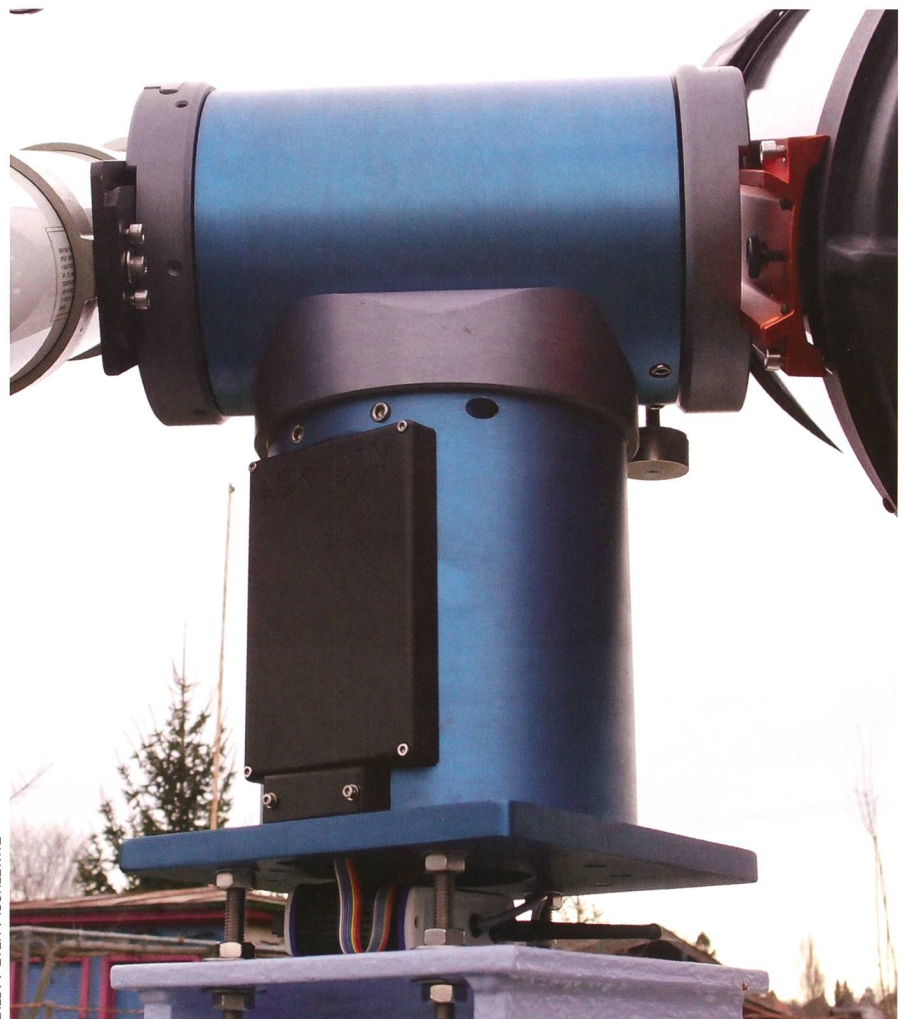
Abbildung 1: «Atlas V24». Zwischen dem Flansch der Montierung und der Abschlussplatte der Stahlsäule erkennt man die Box mit der Elektronik für Steuerung und WLAN. Für das Aufspielen neuer EEPROM-Software dient eine gängige USB-mini Buchse.
