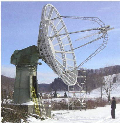
Abbildung 1: Parabolspiegel 100 MHz bis 4 GHz mit 7m Durchmesser in Bleien, Kanton Aargau.
