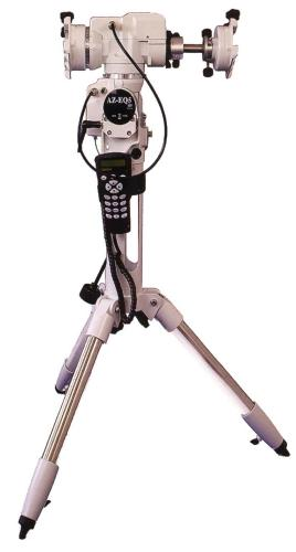
Die neue Montierung von Skywatcher. Kann sowohl äquatorial als auch azimutal eingesetzt werden.
