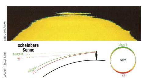
Abbildung 6: Der grüne Strahl entsteht dadurch, dass wir die Sonne durch die unterschiedlich starke Lichtbrechung überlagert sehen. Das rote Licht wird weniger stark angehoben als das blaugrüne.
