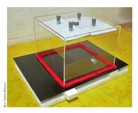
Abbildung 1: Selbst gebaute Nebelkammer zum Nachweis von Teilchenstrahlung.
