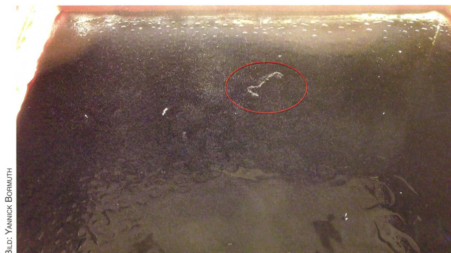
Abbildung 3: Spur eines Beta-Teilchens (Elektron), hervorgehoben durch die elliptische Markierung.
