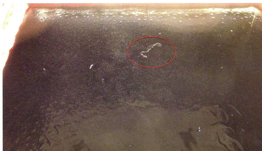
Abbildung 3: Spur eines Beta-Teilchens (Elektron), hervorgehoben durch die elliptische Markierung.
