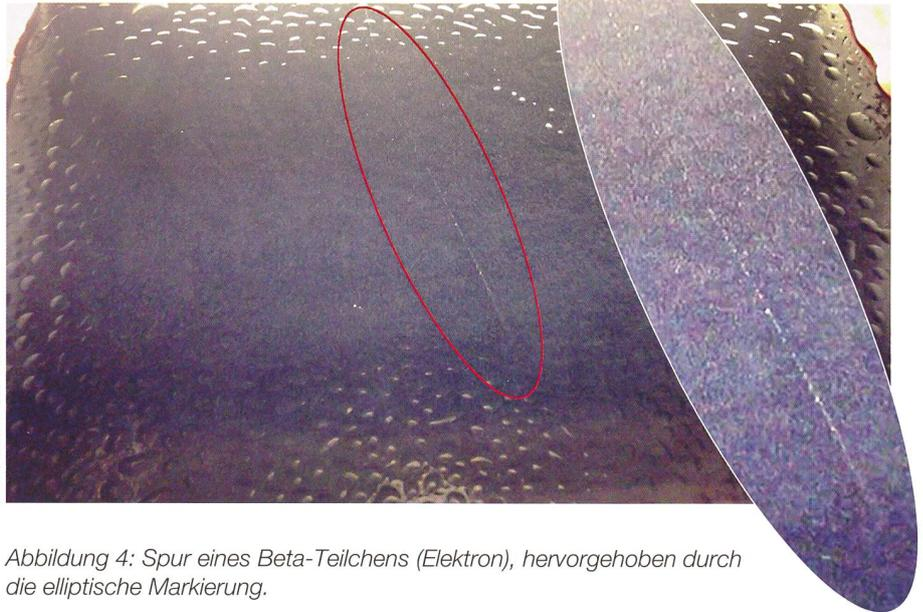
Abbildung 4: Spur eines Beta-Teilchens (Elektron), hervorgehoben durch die elliptische Markierung.
