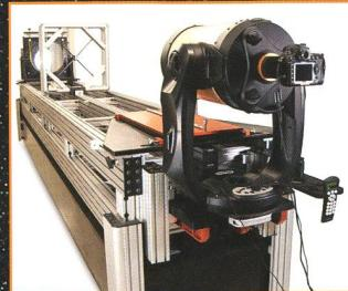
Jedes Edge HD wird auf diesem speziellen Teststand fotografisch getestet.
