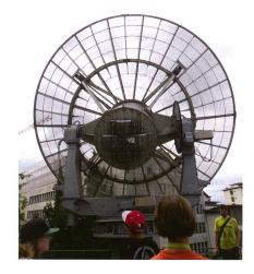
Abbildung 1: Kinder bestaunen die 5 m-Parabolantenne zum Empfang der 21 cm Strahlung von der Sonnenkorona auf der Terrasse des Sonnenturms der ETH Zürich. (Bild: Christian Monstein)
