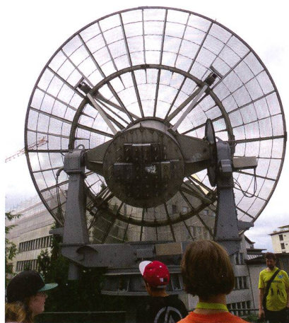
Abbildung 1: Kinder bestaunen die 5 m-Parabolantenne zum Empfang der 21 cm Strahlung von der Sonnenkorona auf der Terrasse des Sonnenturms der ETH Zürich. (Bild: Christian Monstein)
