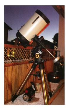
Abbildung 1: Die Aufnahme zeigt die solide Celestron Advanced VX mit aufgesatteltem Edge HD 9.25-Teleskop. (Bild: Jan de Lignie)
