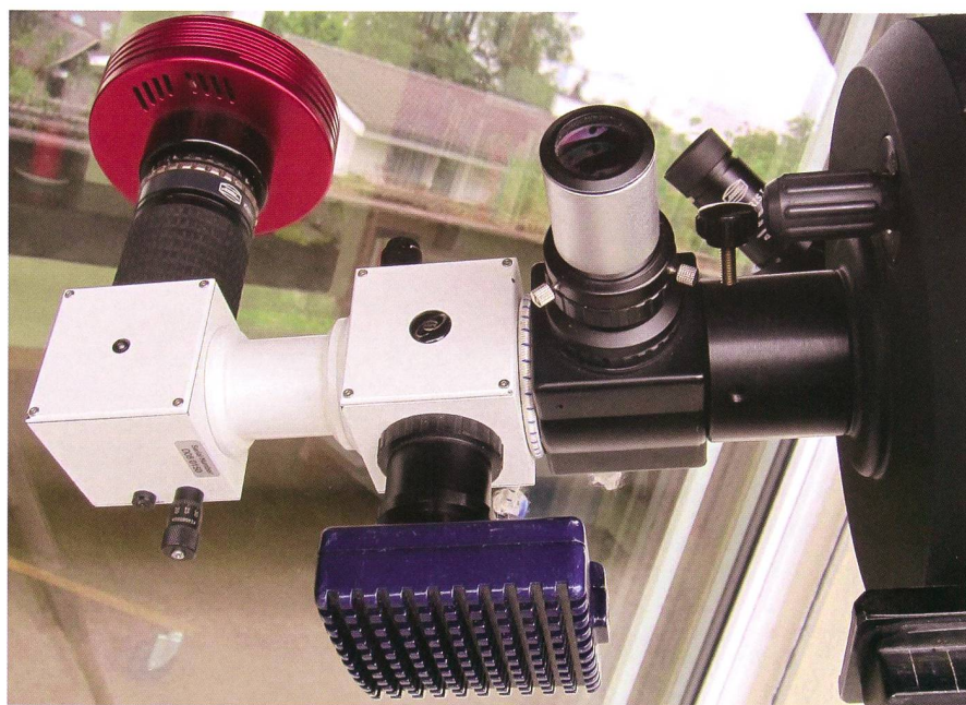
Abbildung 1: DADOS-Spektrograf mit vorgeschaltetem Klappspiegel, Spaltkamera DSI II und Aufnahmekamera Atik 314L+. (Bild: Richard Walker)
