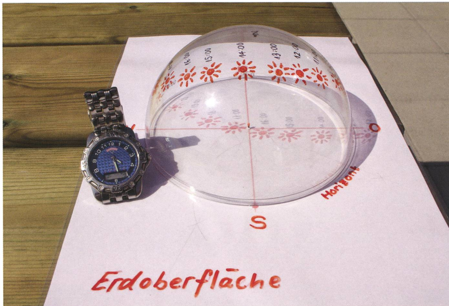
Abbildung 4: Die perfekte Sonnenuhr für einmal anders. Die auf das Modell-Männchen projizierten Sonnenbilder geben jeweils die volle Stunde an. Hier ist der Sonnentagbogen vom 15. Juli dargestellt. (Bild: Thomas Baer)
