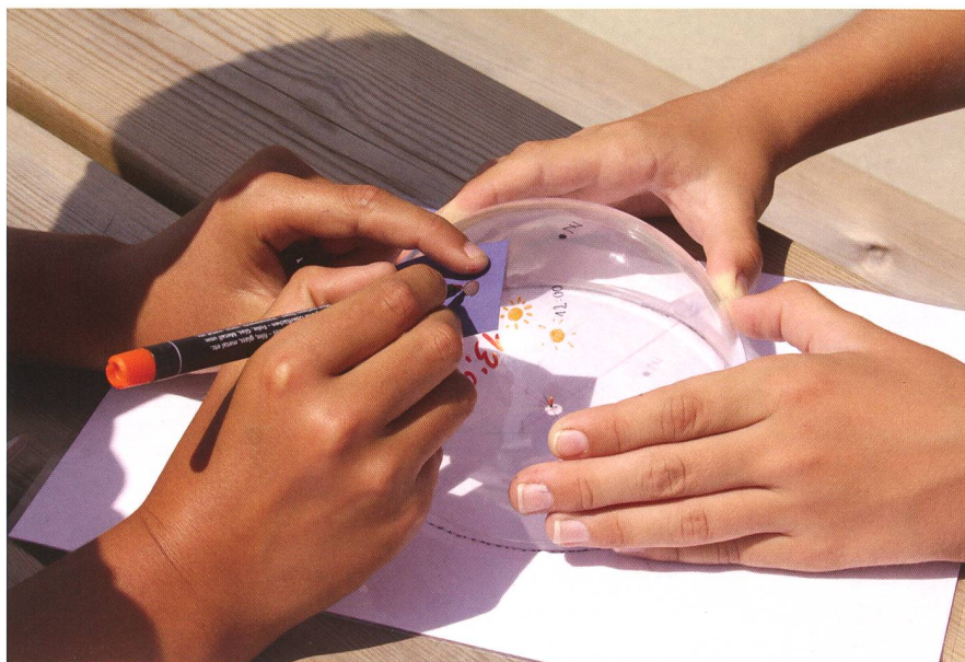
Abbildung 3: Durch eine Lochblende wird die Sonnenposition auf die PVC-Halbku-gel aufgezeichnet. Wichtig ist, dass das Modell-Männchen in der Mitte vom Lichtstrahl getroffen wird. (Bild: Thomas Baer)
