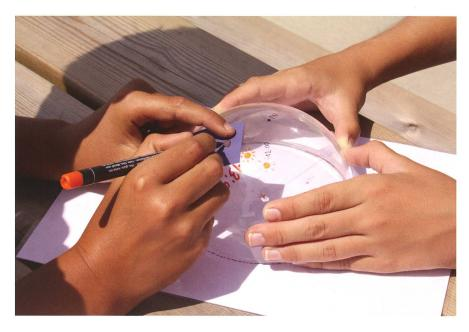
Abbildung 3: Durch eine Lochblende wird die Sonnenposition auf die PVC-Halbkugel aufgezeichnet. Wichtig ist, dass das Modell-Männchen in der Mitte vom Lichtstrahl getroffen wird. (Bild: Thomas Baer)
