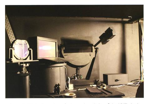
Abbildung 5: Teil des Czerny-Turner-Spektrographen mit einem Spiegel (M5), der das Licht vom FPI kommend (nicht im Bild, aber rechts zu denken) zum Kollimator umlenkt, welcher sich hinter dem Fotografen befindet. Gleich daneben das optische Gitter (G) (180 x 360 mm, 316 Linien/mm, Blaze-Winkel 63.5°) und rechts davon der rechteckige Spiegel (M6), der das Spektrum nach oben in den Beobachtungsraum leitet (v. l. n. r.). Vergleiche auch mit Abb. 6 unten zum Strahlengang. (Bild: Jörg Schirmer)
