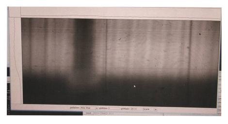
Abbildung 7: Diese Aufnahme zeigt die H-alpha-Linie am Sonnenrand gleichzeitig in Absorption und Emission. (Bild: Jörg Schirmer)
