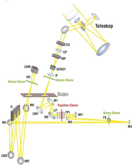
ohne FPI betrieben werden. Dazu wird der in Abb. 6 mit CM1 bezeichnete Spiegel ausgeschwenkt und ein anderer, dort nicht eingezeichneter Spiegel in den Strahlengang eingeschwenkt, sodass die optischen Elemente von CM1 bis M4 inaktiv sind. Weiterhin kann auch eine adaptive Optik zugeschaltet werden.
