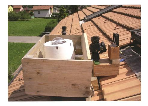
Abbildung 1: Die Videokamera liegt links, unter der kleinen transparenten Kuppel. Rechts steht die Fotokamera (eine Canon 350D), die ebenfalls auf den Zenit gerichtet ist. Um den Tau auf der Frontlinse zu vermeiden, habe ich einen 12V-Ventilator neben den Fotoapparat gestellt. (Bild: Stefano Sposetti)
