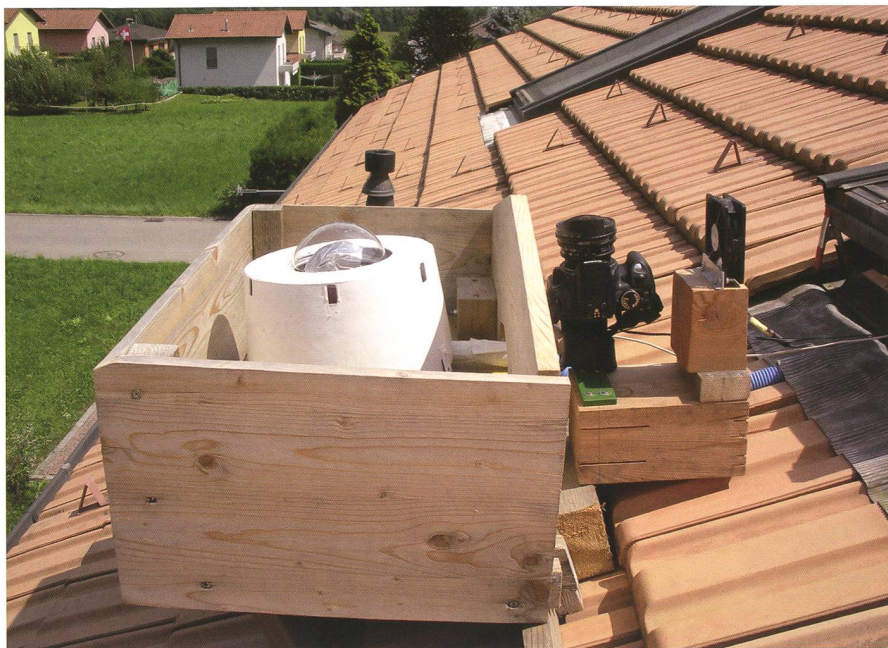
Abbildung 1: Die Videokamera liegt links, unter der kleinen transparenten Kuppel. Rechts steht die Fotokamera (eine Canon 350D), die ebenfalls auf den Zenit gerichtet ist. Um den Tau auf der Frontlinse zu vermeiden, habe ich einen 12V-Ventilator neben den Fotoapparat gestellt. (Bild: Stefano Sposetti)
