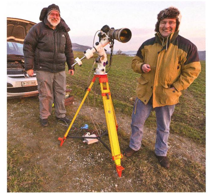
Abbildung 6: Für Bild 5 verwendete Fotoausrüstung: Canon EOS 5D Mark III mit Canon Objektiv 50 mm f4 auf Vixen GP D2. Als Stromquelle dient die Autobatterie. Eine steife Bise und Temperaturen unter dem Gefrierpunkt machen «polare» Kleidung erforderlich. (Bild: Jürg Alean)
