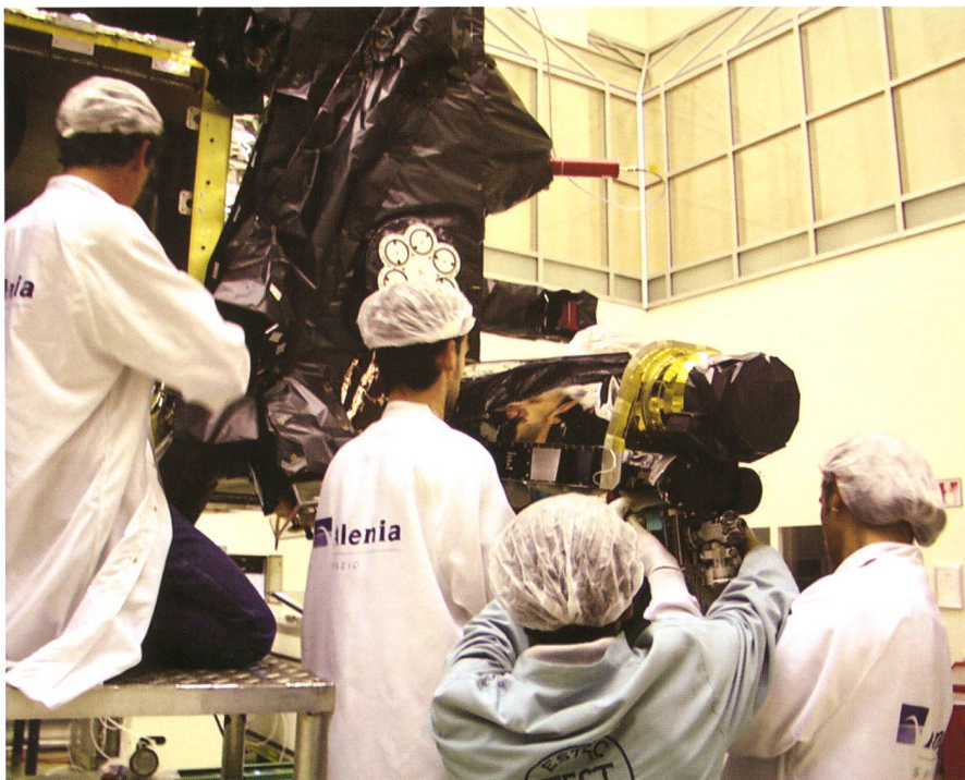
Abbildung 1: Einbau von ROSINA (Rosetta Orbiter Spectrometer for Ion and Neutral Analysis) und des Flugzeitmassenspektrometers RTOF (Reflectron time-of-flight) in Rosetta beim ESTEC (European Space Research and Technology Centre).
