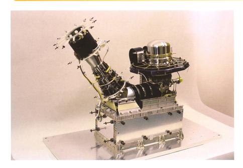
Abbildung 3: ROSINA-Doppelfokussierendes Massenspektrometer (DFMS).
