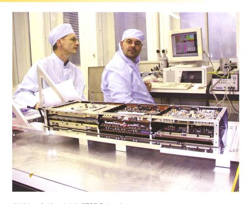
Abbildung 2: Hier wird die RTOF-Elektronik getestet.
