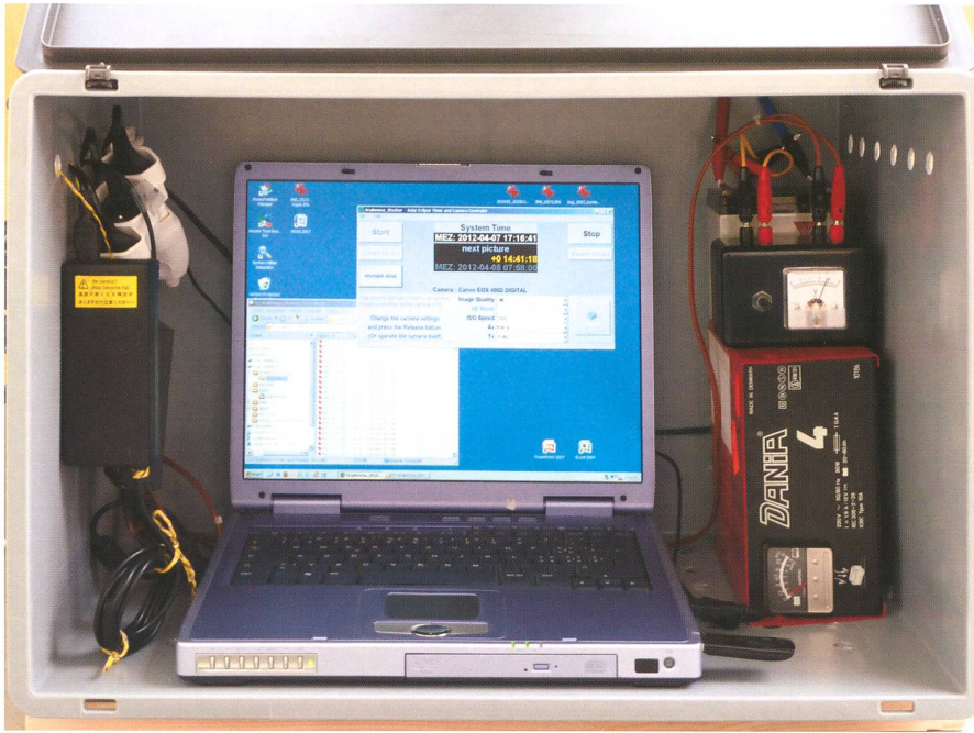
Abbildung 3: Die Steuer- und Kontrollkiste. Links sind die Netzteile, in der Mitte der PC zur Kamerasteuerung, rechts die zusätzliche Spannungsversorgung für die Kamera. (Bild: Robert Nufer)
