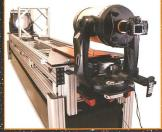
Edge:HD wird auf diesem peziellen Teststand fotogra-sch getestet
