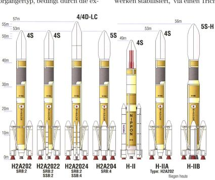
Abbildung 2: Die japanische H2- und H-II-Raketenfamilie. Die H-IIA und H-IIB sind derzeit im Einsatz. Der letzte Start einer H-IIB-304 erfolgte am 21. Juli 2012, Ende Januar 2013 soll eine H-IIA den Erdbeobachtungssatelliten IGS Radar 4 in eine Umlaufbahn bringen. (Grafik: Wikimedia Commons)
