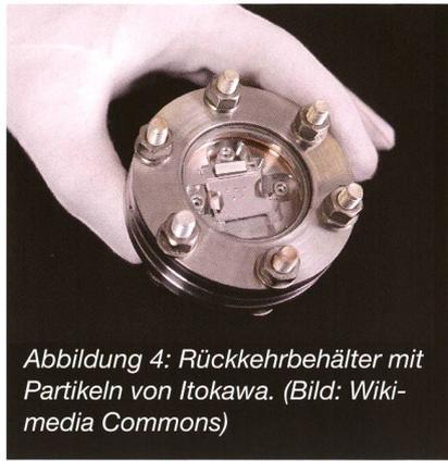
Abbildung 4: Rückkehrbehälter mit Partikeln von Itokawa. (Bild: Wikimedia Commons)
