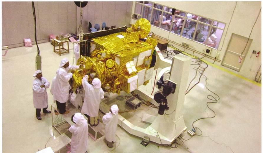
Abbildung 4: Die erste indische Mondsonde Chandrayaan-1 bei der Endmontage. Die Sonde lieferte ab November 2008 über 300 Tage lang Informationen und Bilder des Mondes zur Erde. (Bild: ISRO / Archiv Schmidt)
