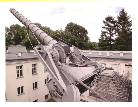
Abbildung 3: Der grosse, rund 21 Meter lange und voll funktionsfähiger Refraktor der Archenhold-Sternwarte ist mit seinen 68 cm Öffnung bis heute ein beeindruckendes Instrument geblieben. (Bild: Markus Griesser)
