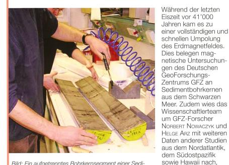
Bild: Ein aufgetrenntes Bohrkernsegment einer Sedi-
