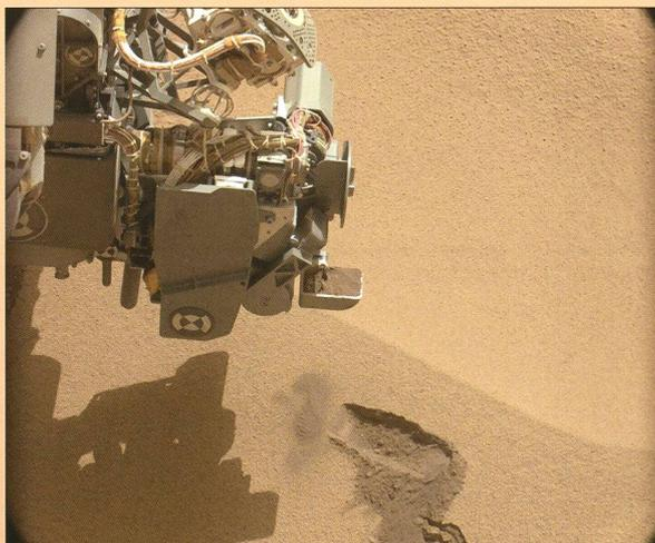
Abbildung 2: Mit Hilfe einer kleinen Schaufel werden Bodenproben genommen, die anschliessend im Sample Analysis at Mars-System (SAM) und im Chemistry & Mineralogy-System (Che-Min) genau untersucht werden. Für Aufregung sorgte ein kleines Stück Plastik, das möglicher-weise vom Rover selbst stammt, die Mission aber nicht beeinträchtigt. (Bild: NASA/JPL-Caltech / Archiv Schmidt)
