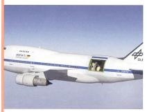
Bild: SOFIA fliegt über Südkalifornien; das in Deutschland gebaute Teleskop mit 2,70 m Öffnung ist zu sehen. (Foto: NASA)
