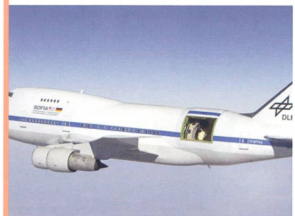
Bild: SOFIA fliegt über Südkalifornien; das in Deutschland gebaute Teleskop mit 2,70 m Öffnung ist zu sehen. (Foto: NASA)
