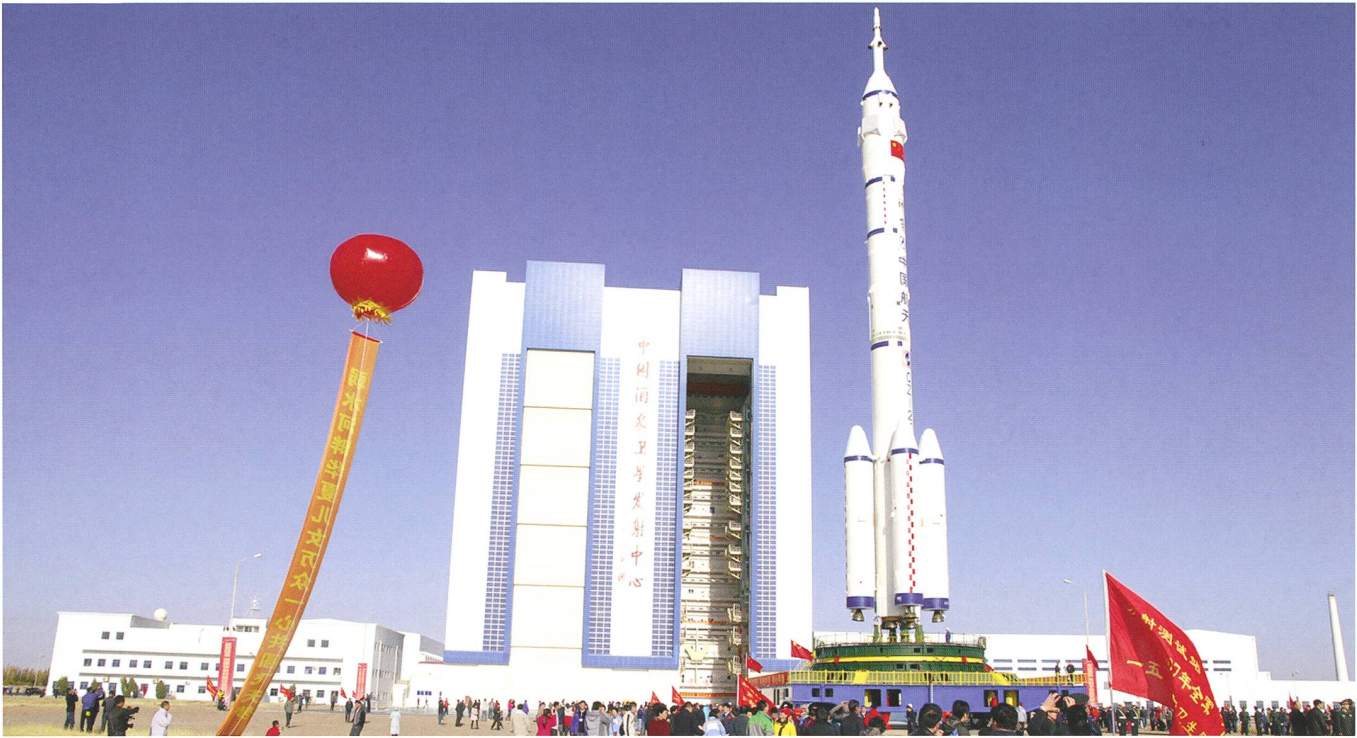
Abbildung 2: Unter grossem Pomp wird jeweils der Roll-out der CZ-2F Trägerrakete auf dem Startkomplex von Jiuquan vorgenommen. Die 62 Meter hohe Trägerrakete wird auf dem Schienenweg zur 1500 Meter entfernten Abschussrampe gerollt. (Bild: Xinhua/Archiv Schmidt)
