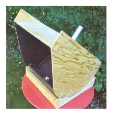
Abbildung 5: Das Solarscope als Holzmodell. Das Original besteht aus stabilem Karton; die optischen Bauteile wurden diesem Bausatz entnommen. Das Aluminiumrohr enthält das Objektiv, welches das Sonnenbild auf einen kleinen Kugelspiegel wirft. Dieser befindet sich in einer Metallfassung (unten links im Bild), welche zum Fokussieren mit einem Schraubgewinde verstellt werden kann. Das Sonnenbild erscheint gross auf der Innenseite der Vorderwand.
