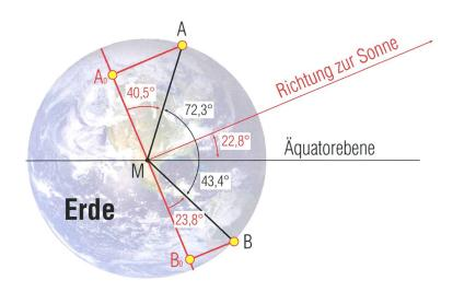
Abbildung 2: Die Basislinie  $A_0B_0$  steht senkrecht auf der Richtung zur Venus. Deren Deklination beträgt am 6. Juni 22.8°. Mit dem Erdradius von 6372 km erhält man 10'675 km für die Strecke  $A_0B_0$ . (Grafik: Thomas Baer nach Hans Roth)
