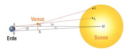
Abbildung 3: Die Rechnung zu dieser Methode ist einfach. Die Strecke  $VA_2$  ergibt sich durch den beobachteten Mittelpunktsabstand  $\alpha$  und die Entfernung der Venus in AE, im Beispiel also zu 0.2887 AE  $\cdot$  tan (538.1") = 0.000753157 AE und entsprechend wird  $VB_2 = 0.000801866$  AE. Für den gesuchten Winkel x ist also tan (x) =  $A_2B_2$ /0.7260 und x ist 13.84". Das ist aber auch der Winkel, unter dem die Basislinie  $A_0B_0$  gesehen wird. (Grafik: Thomas Baer nach Hans Roth)
