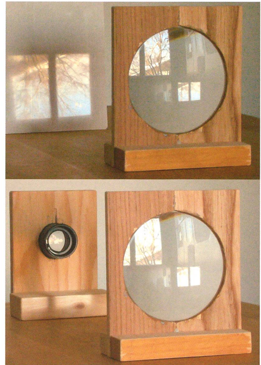
Abbildung 11 und 12: Eine Sammellinse (das Fernrohr-Objektiv) erzeugt auf einem weissen Karton das umgekehrte Bild eines Fensters. Nach Entfernen des Kartons bleibt dieses reelle Zwischenbild im Raum erhalten. Mit dem Okular betrachtet man das Zwischenbild von hinten her wie mit einer Lupe. Wir sehen ein virtuelles Bild. (Bilder: Erich Laager)
