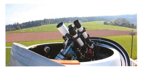
Abbildung 1: Auf der Dachterrasse des 12.5 m hohen Sonnenturms Uecht im bernischen Niedermuhlern steht unter einer 2.1 m Clamshell Kuppel von Astro Heaven auf einer GM2000 Montierung das Robotic Solar Observation Telescope (roboSOT) mit drei fernsteuerbaren Instrumenten zur Überwachung der Sonnenaktivität im weissen Licht, in Ca II K sowie in H-alpha. (Bild: Thomas K. Friedli)
