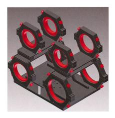
Abbildung 2: Die mittels 3D CAD entworfenen justierbaren Rohrschellen.
