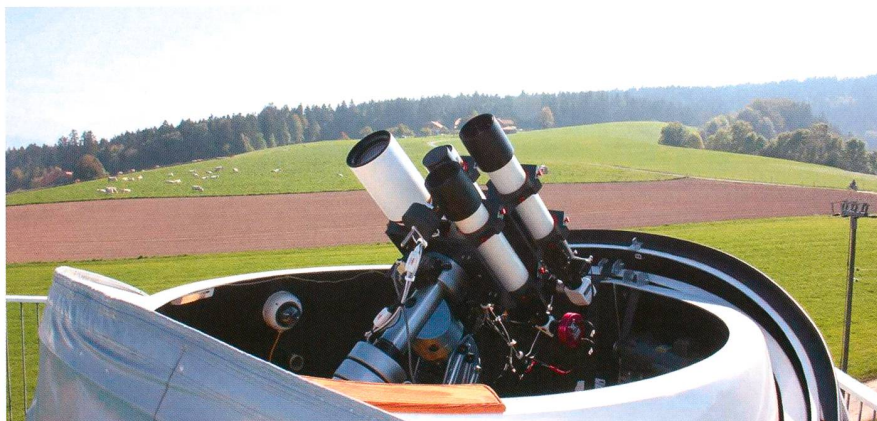
Abbildung 1: Auf der Dachterrasse des 12.5 m hohen Sonnenturms Uecht im bernischen Niedermuhlern steht unter einer 2.1 m Clamshell Kuppel von Astro Heaven auf einer GM2000 Montierung das Robotic Solar Observation Telescope (roboSOT) mit drei fernsteuerbaren Instrumenten zur Überwachung der Sonnenaktivität im weissen Licht, in Ca II K sowie in H-alpha. (Bild: Thomas K. Friedli)
