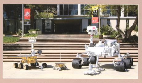
Abbildung 9: Drei Generationen von Marsfahrzeugen: Links MER («Spirit» & «Opportunity»), in der Mitte der kleine «Sojourner» und rechts das Mars Science Laboratory «Curiosity». Letzterer hat Räder, die so gross sind wie die Höhe von «Sojourner». (Bild: NASA-JPL/ Archiv Schmidt)
