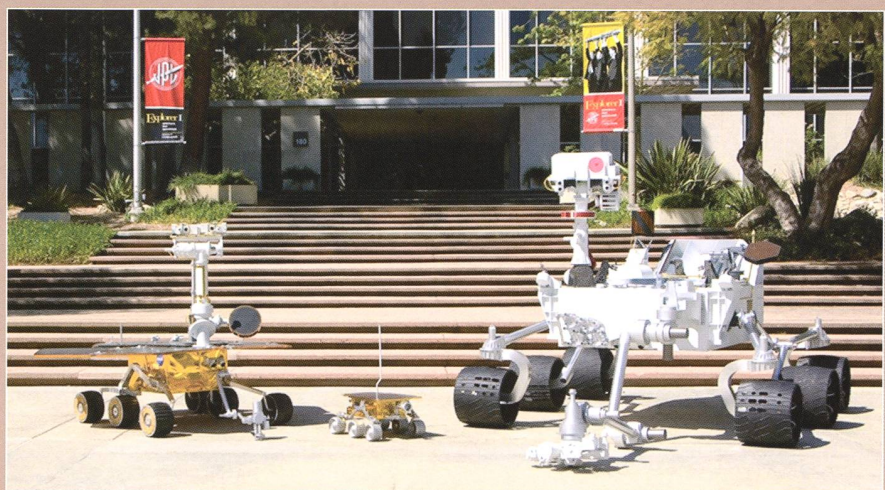
Abbildung 9: Drei Generationen von Marsfahrzeugen: Links MER («Spirit» & «Opportunity»), in der Mitte der kleine «Sojourner» und rechts das Mars Science Laboratory «Curiosity». Letzterer hat Räder, die so gross sind wie die Höhe von «Sojourner». (Bild: NASA-JPL/ Archiv Schmidt)
