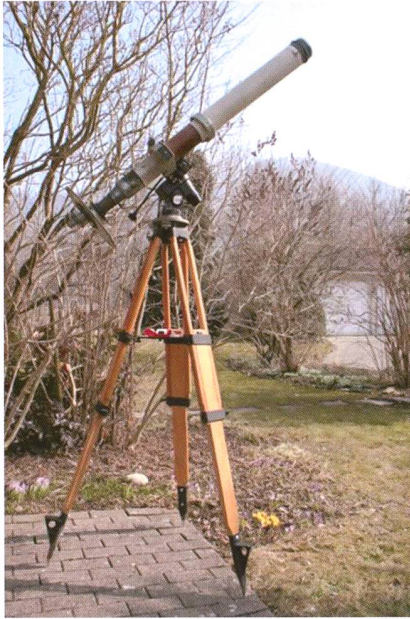
Abbildung 2: Der seit 1855 zur täglichen Bestimmung der Sonnenfleckenzahl benutzte 83/1300 mm-Fraunhoferrefraktor von RUDOLF WOLF. Implizite wurden und werden alle zur Messung der langfristigen Veränderungen des Sonnenklimas genutzten Zählungen von Gruppen und Einzelflecken auf dieses Instrument geeicht. Seit 1996 werden die Standardbeobachtungen im Auftrag der RUDOLF WOLF Gesellschaft von Dr. THOMAS K. FRIEDLI durchgeführt.
