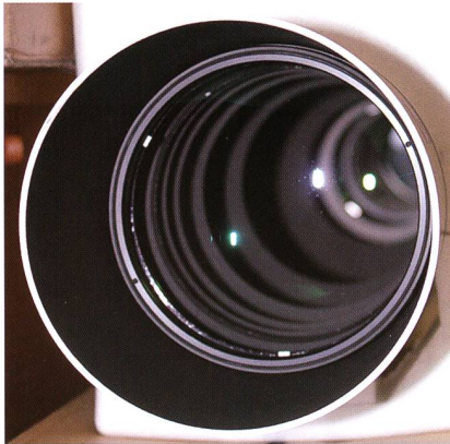
Abbildungen 3 und 4 (unten): Korrekt eingebaute Blenden...
