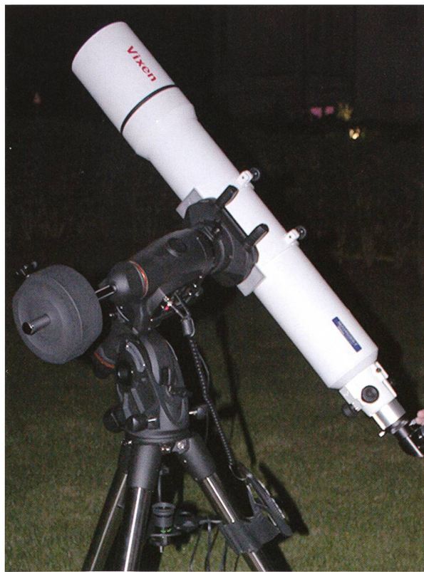
Abbildung 1: Der Vixen NA140 auf einer Celestron CGEM-Montierung; eine schöne und sehr stabile Kombination. (Bild: Jan de Ligne)
