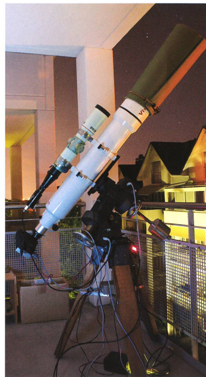
Abbildung 2: Der NA140 in astrofotografischer Montur mit Pentax 75SDHF als Leitrohr auf AOK WAM300-Montierung; so entstand Abbildung 8. (Bild: Jan de Ligne)
