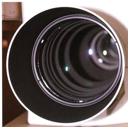
Abbildungen 3 und 4 (unten): Korrekt eingebaute Blenden...
