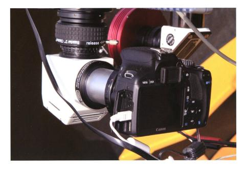
Abbildung 3: Canon EOS 550D DSLR-Kamera mit aufgesetzter Sucherabdeckung, weissem USB 2.0 Datenübertragungs- und Steuerungskabel sowie ACK-E8-Stromversorgungskit am umgebauten Baader Cool-Ceramic Safety Herschelprisma des TeleVue NP-101is-Refraktors. Im Hintergrund das Ca II K Diagonal von Lunt mit der Atik 320e CCD-Kamera.
