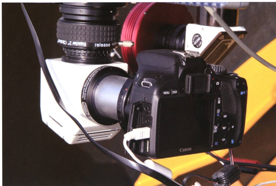
Abbildung 3: Canon EOS 550D DSLR-Kamera mit aufgesetzter Sucherabdeckung, weissem USB 2.0 Datenübertragungs- und Steuerungskabel sowie ACK-E8-Stromversorgungskit am umgebauten Baader Cool-Ceramic Safety Herschelprisma des TeleVue NP-101is-Refraktors. Im Hintergrund das Ca II K Diagonal von Lunt mit der Atik 320e CCD-Kamera.
