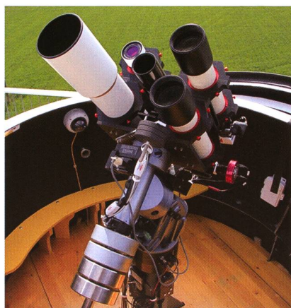
Abbildung 2: Der 4" Televue NP-101is Refraktor mit fernsteuerbarem JMI Fokussierungsmotor auf der deutschen 10micron GM2000 Montierung des Sonnenturms Uecht in Niedermuhlern (rechts oben), ausgerüstet mit dem Baader Cool-Ceramic Safety Herschelprisma und einer Canon 550D DSLR-Kamera. Aufnahme Mai 2011.
