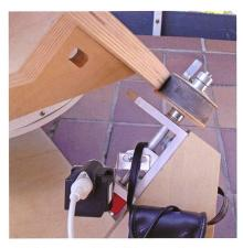
Abbildung 10: Nachführung mit Getriebe-Schrittmotor.
