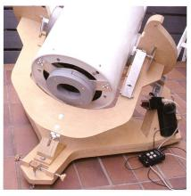
Abbildung 6: Stützlager mit Rolle und Stütze.
