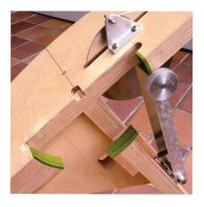
Abbildung 8: Die Filzlagerung der Höhenräder und die Schwinge mit Zahnriemenscheibe und Zugfeder.
