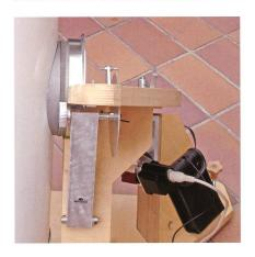
Abbildung 11: Das Deklinationsgetriebe i = 1:4.
