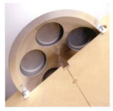
Abbildung 9: U-förmige Abstandshalter stützen die Höhenräder seitlich ab.
