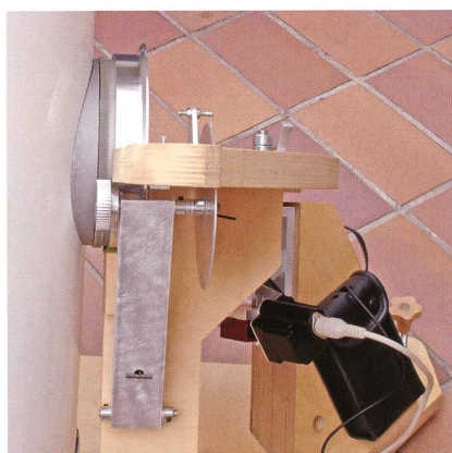
Abbildung 11: Das Deklinationsgetriebe i = 1:4 .
