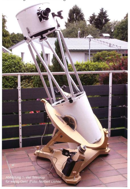
Dem Autor ist es mit seiner selbst konstruierten und gebauten parallaktischen Hufeisenmontierung gelungen, diesen Nachteil zu beseitigen, ohne dabei die Vorteile einzubüssen. Herausgekommen ist ein bezahlbares, Aufsehen erregendes Teleskop (Abb. 1), das alle Voraussetzungen für ungetrübten Beobachtungsgenuss mitbringt und auf dem ITV 2009 prämiert wurde (Abb. 2).
