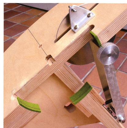
Abbildung 8: Die Filzlagerung der Höhenräder und die Schwinne mit Zahnriemenscheibe und Zugfeder.
