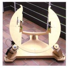
Abbildung 5: Zwei Holzrollen bilden das Nordlager der Polachse.
