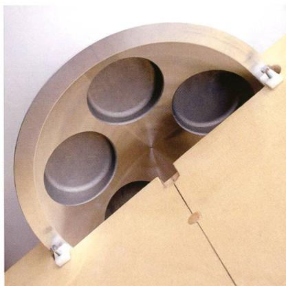
Abbildung 9: U-förmige Abstandshalter unterstützen die Höhenräder seitlich ab.
