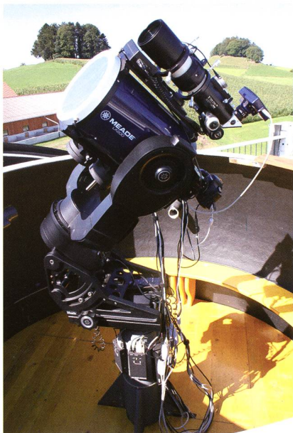
Abbildung 2: Der TeleVue TV-76 Refraktor huckepack montiert auf dem 8" Meade LX200R des Sonnenturms Uecht in Niedermuhlern, ausgerüstet mit dem Lunt Ca II K Diagonal und der monochromen Meade DSI III pro Webcam. Das ferngesteuerte Fokussieren erfolgt mit dem TeleVue Focusmaster mit 1 Mikron Ablesegenauigkeit.
