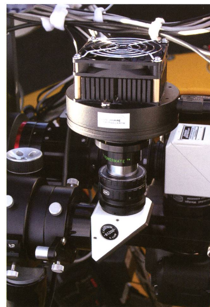
Abbildung 4: Die Astrolumina Alccd 9 Kamera mit vorgeschalteter Barlowlinse im nachgerüsteten Baader Okularstutzen des Lunt Ca II K Diagonalmoduls.
