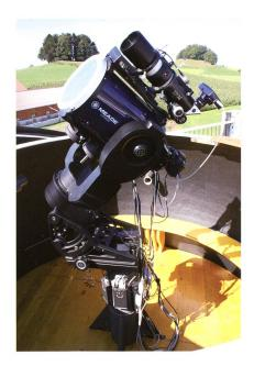
Abbildung 2: Der TeleVue TV-76 Refraktor huckepack montiert auf dem 8" Meade LX200R des Sonnenturms Uecht in Niedermuhlern, ausgerüstet mit dem Lunt Ca II K Diagonal und der monochromen Meade DSI III pro Webcam. Das ferngesteuerte Fokussieren erfolgt mit dem TeleVue Focusmaster mit 1 Mikron Ablesegenauigkeit.
